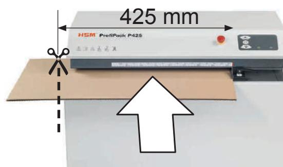
Posizionare il cartone sulla battuta a destra e spingerlo nell'apertura di alimentazione fino a quando non viene afferrato dall'utensile da taglio. Rilasciare immediatamente il cartone. Il cartone perforato esce dallo slot.
